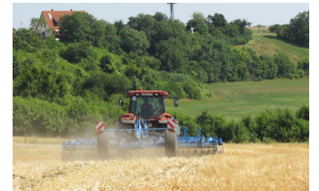
Schon einen Tag nach der Ernte der Wintergerste auf den Feldern nördlich des Cospedaer Grundes ist eine Kurzscheibenegge der Gönnatal Agrar e.G. im Einsatz. Sie dient der intensiven
