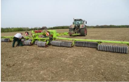
Auf Nachfrage war zu erfahren, dass auf diesem Acker eine Mais-Saat nicht auf konventionelle Weise, sondern mittels des modernen Stripp-Till- Verfahrens eingebracht wird.
