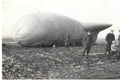
Beispiel eines Sperrballons von denen es um Jena 20- 25 gab. Rechts Seilwinde mit der der Ballon an Stahlseilen aufgelassen bzw. herunter geholt wurde(Wikipedia).
