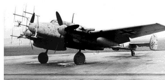
*Me Bf 110 G-4 mit Radarantennen „Hirschgeweih“, ein zweimotoriger schwerer Langstreckenjäger. Länge 12m, Spannweite 16 m, Produktionszahl 5760 Stck. (Foto Wikipedia).*
