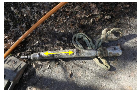
Bohrkopf mit Rollenmeißel. Im markierten Bereich ist die zur Ortung des Bohrkopfes erforderliche zylindrische Sonde eingebaut.
