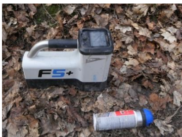
Ortungsgesät, das über Funk die Raumlage des Bohrkopfes erkennen lässt und diese auch auf den Monitor im Führerstand des Bohrgerätes überträgt.
