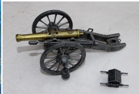
Modell eines Feldgeschützes System Gribeauval, wie es auf nebenstehender Zeichnung dargestellt ist.
