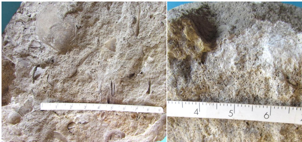
↑ 2.3-8 links: Schaumkalk, Blick auf eine Schichtfläche mit Steinkernen verschiedener Schalentiere. (Muscheln, Schnecken, Röhren von Dentalium). Rechts: Deutlich erkennbar die offenen Poren und rechts der beim Anschlagen mit dem Hammer entstandene „Mehlstaub“ („Mehlbatzen“).
