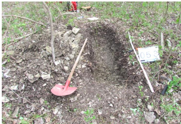
4.6-2 Geologischer Handschurf im Westteil des ZP 2. Bis 0,4 m Tiefe locker gelagertes Aufschüttungsmaterial.
